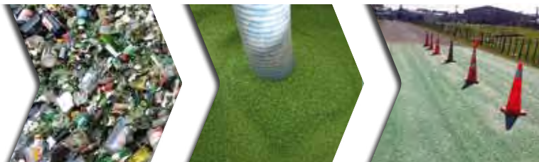
De gauche à droite, déchets de verre après collecte, broyage du verre, et enfin utilisation en travaux publics
